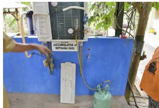
写真12. 実験中のメタンガス充填装置（筆者撮影）
